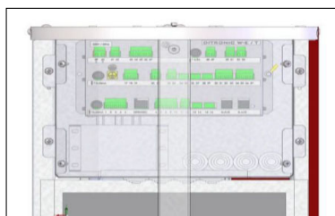
Unidad de control – Terminales de conexión
